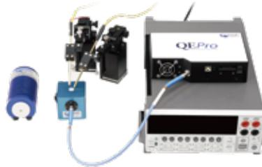
方案二:高灵活度探针台方案,单点测试,小体积异形样品均适用,1.5寸积分球,可以测试低亮度样品,安装方便,小巧灵活。
