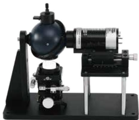
PL系统针对手套箱做了易用化的设计, 采用升降台承载样品防止手持造成洒落, 在保证操作方便的同时, 保证了每次安装的位置都相同, 降低了人为操作的误差, 提高了整体测试过程中的结果可靠度。
