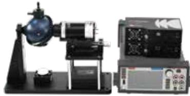
方案一:集成化程度高,适配无线遥控自动化测试,3.3寸积分球更适合高亮度样品,可以根据器件定制专用夹具,且能进行PL扩展。
